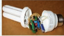
شكل (١) لمبة مدمجة موفرة موضحة فيها البلاست الإلكتروني
