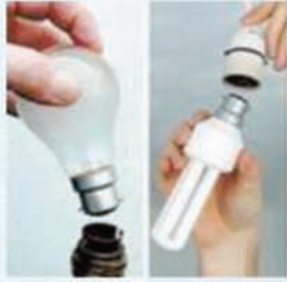
شكل (٤) استبدال اللبمبة العادية باخرى مدمجة موفرة توفر حوالي ٧٥ ٪ من استهلاك الكهرباء
